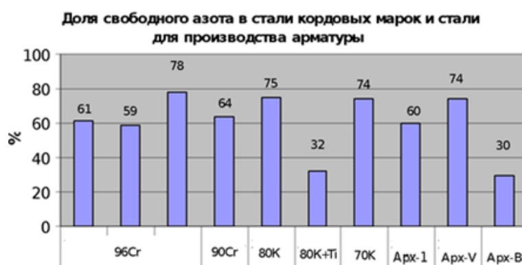
Рис. 16. Доля свободного азота в исследуемых образцах кордовой и арматурной стали
